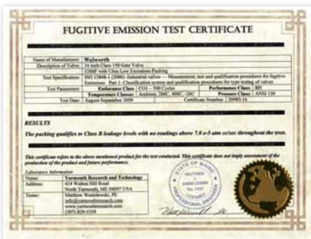
Certificado de Emisiones Fugitivas de 500 ciclos para Válvulas de compuerta de 16" clase 150#, emitido por Yarmouth Research and Technology, que califican toda la gama de productos de Acero Fundido.
