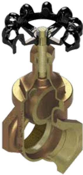
Cuña Sólida de Bronce de acuerdo con ASTM B62 C83600 para vástago fijo (no ascendente, sólo aplica para las válvulas W4 y W14).
