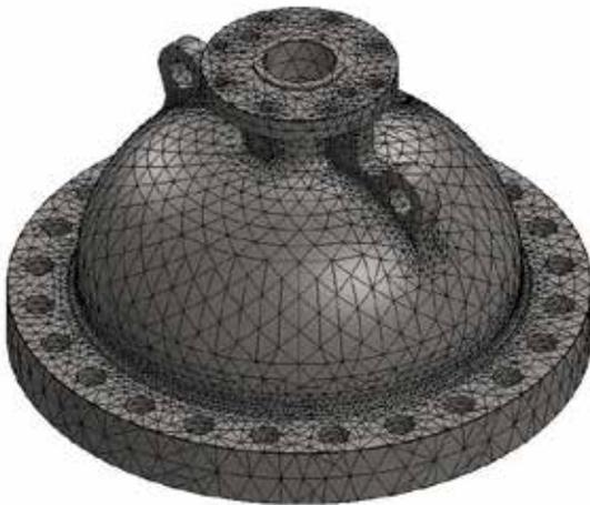
MALLA DE ELEMENTOS FINITOS USADA EN
