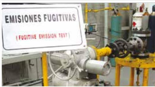
**Equipo de Pruebas de Bajas Emisiones Fugitivas.**- Se aplica cuando un cliente requiere un Certificado de Bajas Emisiones Fugitivas. El laboratorio tiene su propio equipo LFE capaz de medir menos de 20 ppm en condiciones estáticas o dinámicas, a temperatura ambiente o bajo condiciones de operación de ciclos térmicos.
