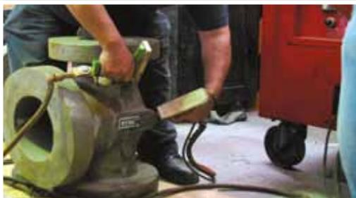
**Prueba de Partículas Magnéticas.**- WALWORTH cuenta con el equipo para pruebas por partículas magnéticas aplicada a materiales ferrosos susceptibles a magnetismo. Esta prueba se realiza por muestreo o cuando el cliente solicita la Certificación de Partículas Magnéticas.
